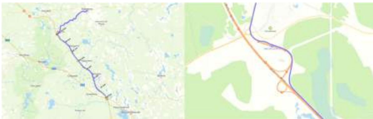
Рис. 1. Оцененная траектория фильтром реального времени, наложенная на карту Фрагмент траектории --- дорожная развязка, 70 километров от точки старта.
