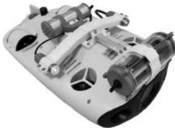
Рис. 2. Подводный дрон с дополнительной камерой и параллельными лазерами
